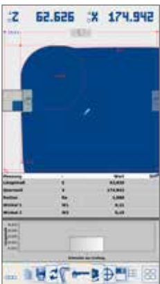
Bis zu 5 Messergebnisse ermitteln (Z, X, Radius, Winkel 1, Winkel 2)
